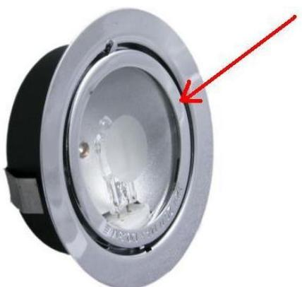
Данный светильник используется с капсулной лампой мощностью 20W с цоколем G4. Для замены лампы не нужно демонтировать светильник из мебели, достаточно при помощи отвертки или ножа отсоединить крепежное кольцо, расположенное между корпусом лампы и стеклом (рис.20), затем вынуть стекло, заменить лампу, установить обратно стекло и кольцо. Убедитесь, что защелки на кольце сработали (Вы услышите щелчок).
