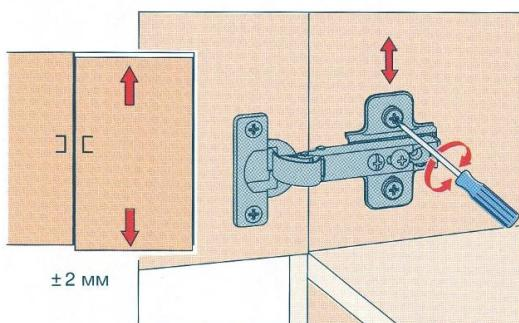
При помощи **ответных планок**, **регулируемых по высоте**, можно точно установить высоту положения двери.
