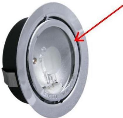
Данный светильник используется с капсульной лампой мощностью 20W с цоколем G4. Для замены лампы не нужно демонтировать светильник из мебели, достаточно при помощи отвертки или ножа отсоединить крепежное кольцо, расположенное между корпусом лампы и стеклом (рис.20), затем вынуть стекло, заменить лампу, установить обратно стекло и кольцо. Убедитесь, что защелки на кольце сработали (Вы услышите щелчок).
