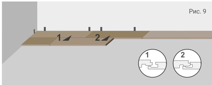
8.3.1.2 Зацепления продольного замка с предыдущим рядом осуществляется с правой стороны примерно на 2/3 длины планки (см. рис. 10). Для того чтобы завершить укладку, необходимо приподнять планки второго ряда со стороны поперечного замка и легким постукиванием рукой или подбивочной планкой сдвинуть планку до полного зацепления с предыдущим рядом (см. рис. 11).
